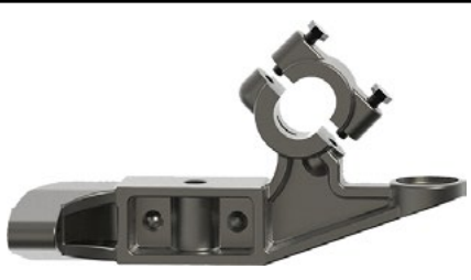
Bracket, Stabilizer Bar, Left With Bearing Cap 1.Dingil Ön Alt Denge Kol Tablası Sol Kepli (83Mm)
